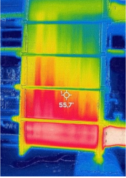
Termal görüntüleme, Terneuzen sahasındaki poliüretan tesisinde Alfa Laval ısı eşanjörlerinden sekizinin değerlendirilmesi sırasında kullanılan tekniklerden biridir. Düzensiz ısı dağılımı, kirlenmenin ve temizliğin gerekli olduğunun açık bir göstergesidir.
